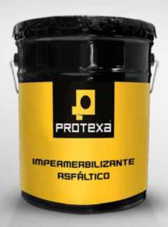
Impermeabilizante fibratado asfáltico emulsionado con rellenos minerales y fibras naturales, libres de asbesto. Para superficies de concreto monolítico con pendiente de 2º a 90º ,puede aplicarse en superficies secas o húmedas (no encharcadas) y en combinación con membranas de refuerzo Cristales o Poliflex.
