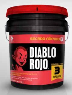
Impermeabilizante asfáltico emulsionado base de agua económico con rellenos minerales y fibras naturales de refuerzo, no contiene asbestos. Posee excelente resistencia a la intemperie y se puede aplicar a superficies húmedas (no encharcadas) o secas de concreto monolítico, con pendientes de 2% a 90%, útil para reparaciones domésticas.
