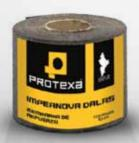
Impermeabilizante prefabricado en forma de banda, de fibra de vidrio, saturada con asfalto y arena sílica en sus dos caras, desarrollado para impermeabilizar la base de los muros, antes de su desplante (Dala de cimentación) para evitar que niveles freáticos o humedad en el suelo suba a los muros.
