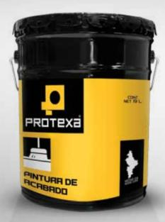
Pintura de aluminio base solvente, usada como acabado protector en sistemas de impermeabilización asfálticos para alargar su vida útil y como reflector térmico para las losas, obteniendo un 95% de reflectancia y alto poder cubriente. Se puede utilizar para renovar el acabado reflectivo en sistemas impermeables asfálticos y como capa reflectiva y anticorrosiva económica sobre techos de lámina o sobre láminas de asbestocemento.
