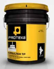
Imprimador de emulsión asfáltica (base agua) para sellar la porosidad de las superficies de concreto y aumentar la adhesividad de los impermeabilizantes asfálticos. Cumple la especificación ASTM D-997 para emulsiones asfálticas aniónicas tipo SS-1H. Al atrapar el polvo y penetrar en el poro, asegura la adherencia de los productos o sistemas impermeables asfálticos de cualquier tipo.
